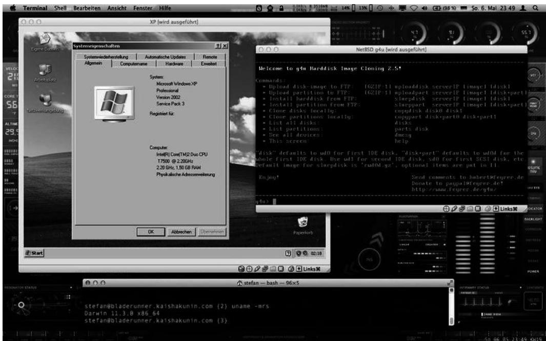
Abbildung 6: VirtualBox emuliert 2 VM für Windows XP und g4u (NetBSD) auf Mac OS X.
